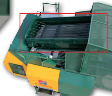
El dispositivo para extracción de ramas **DRM 45/50** soluciona los problemas típicos que causa la entrada masiva de este residuo en las plantas de recepción y procesado de aceituna.
