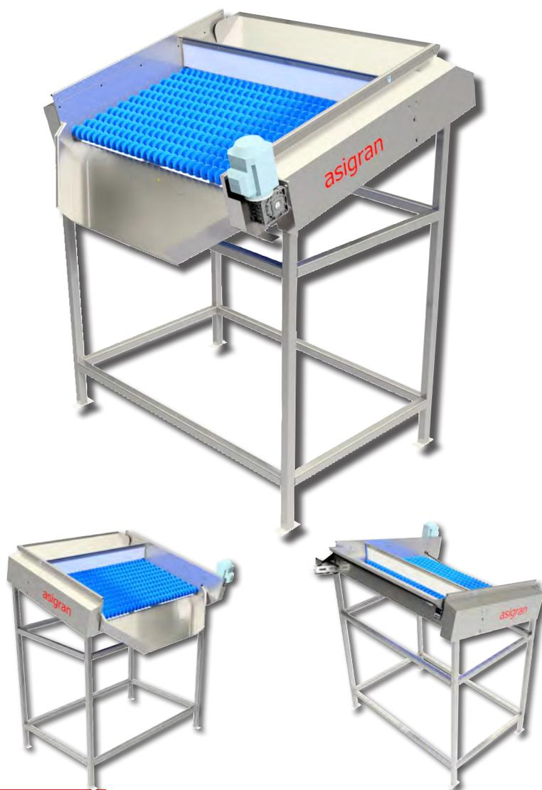
Este dispositivo, que incorporan de serie todos nuestros equipos de lavado de aceituna, está diseñado para separar los palos y pequeñas ramas que suelen quedar con la aceituna tras el proceso de limpieza y lavado.
