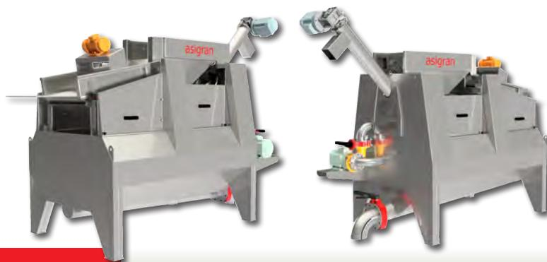
Los Sistemas para Lavado de Aceituna **Aqua LV Millennium Básicos** están diseñados para conseguir óptimos resultados en producciones de entre una y cuatro toneladas por hora, con entrada de aceituna fundamentalmente del árbol.
