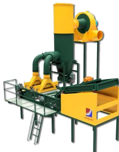
Las **Nuevas Deschinatoras ASP 1200**, formadas por un conjunto de tres dispositivos, están diseñadas para acometer el proceso final de eliminación de piedras y resto de residuos pesados que puedan quedar tras la limpieza previa de la almendra.
